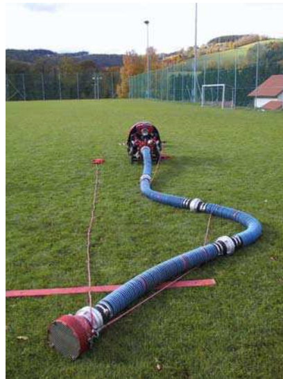
Bild 11 Richtig ausgelegte Saugschlauchleitung
