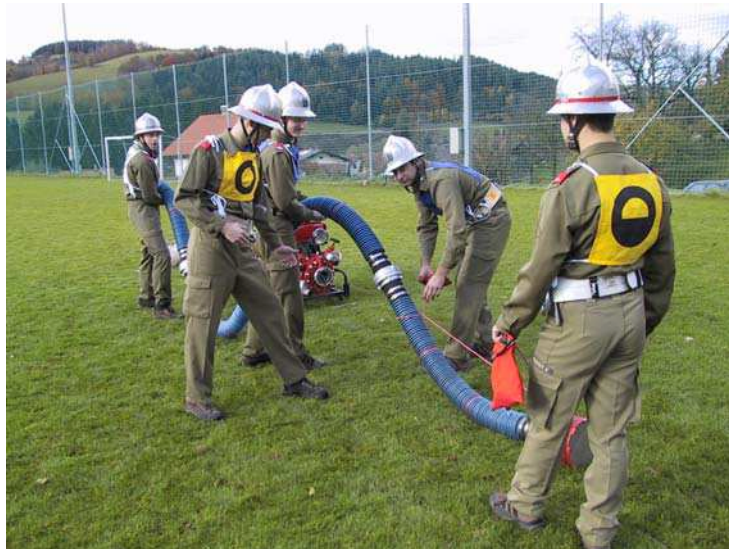
Bild 9 Der Wassertruppführer befestigt die Saugschlauchleine durch einen ganzen Schlag um den wasserseitigen Saugschlauch
