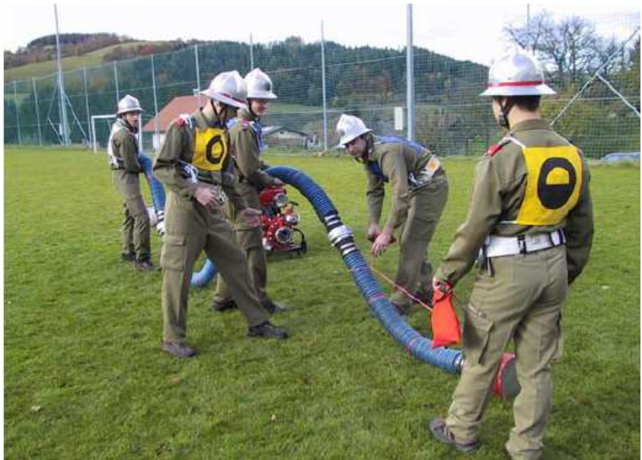
Obrázek 9 Vedoucí vodního oddílu upevňuje lano sací hadice celou otáčkou kolem sací hadice na straně vody
